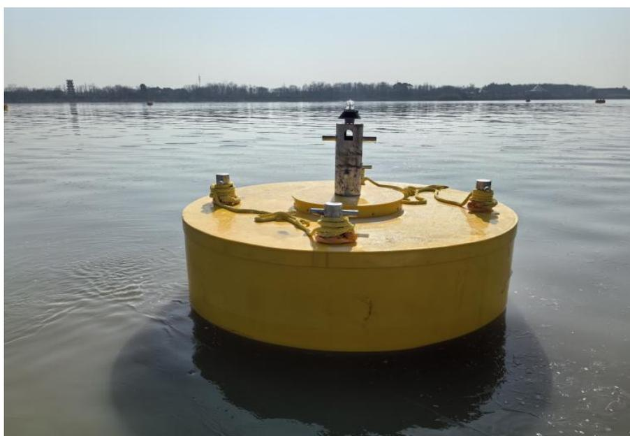
图 6-1 抛设后的超高分子量聚乙烯大型浮鼓
